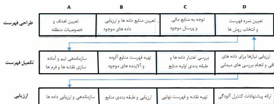
شکل ۳-۱- تهیه فهرست منابع آلاینده پتانسیل
